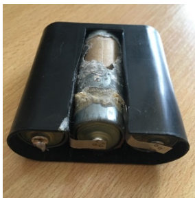
Obr. 22. Vnitřek ploché 4,5 V baterie
