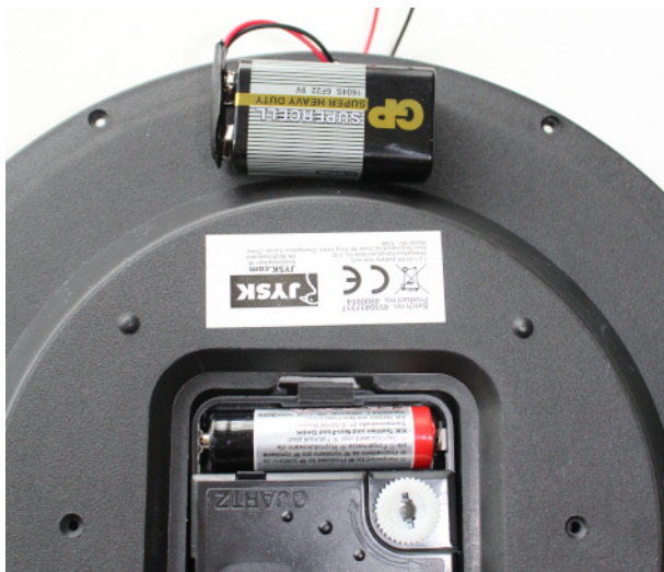
Obr. 10. Baterie 9 V na LED pásek a baterie 1,5 V na hodinový strojek
